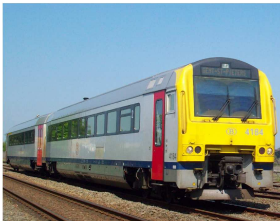
Figuur 9.2: Gebruikelijke NMBS dieseltreinstel van het type MW41. Dit type treinstel heeft, omgerekend naar een driedelige variant, een capaciteit van 207 zitplaatsen 2 e klas en 18 zitplaatsen 1 e klas.
