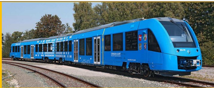
Figuur 9.5: De Coradia iLint (prototype) van Alstom rijdt op waterstof.
