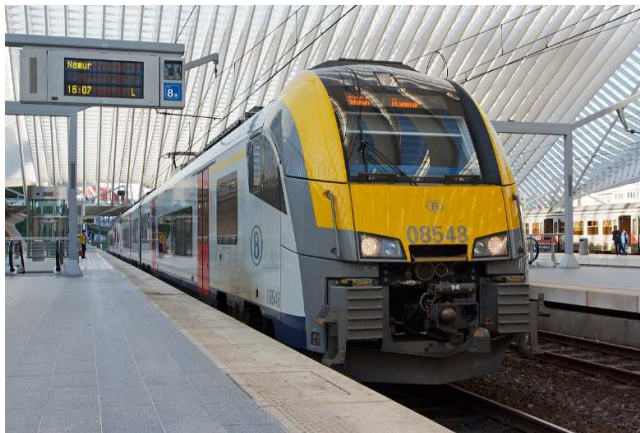
Figuur 9.1: Gebruikelijke NMBS elektrisch treinstel van het type AM08. Dit type treinstel heeft een capaciteit van 232 zitplaatsen 2 e klas en 32 zitplaatsen 1 e klas.
