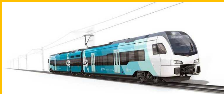
Figuur 9.4: De nieuwe lightrain FLIRTINO van Arriva (Stadler WINK) is geschikt voor exploitatie met partiële bovenleiding.
